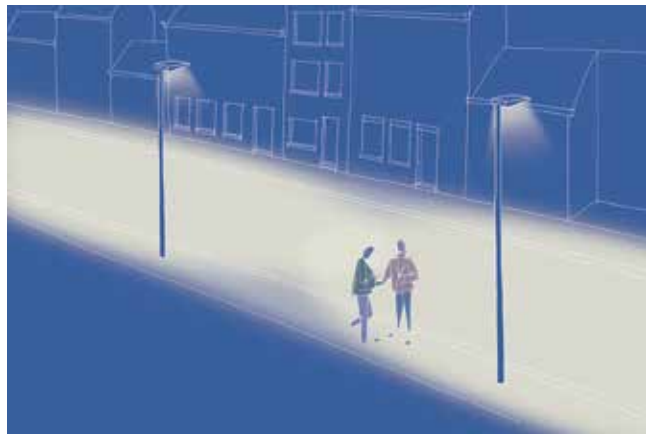
- Optyka LensoFlex2® „Drogi osiedlowe” 5103 - Klasy oświetlenia ME4 zgodnie z CIE 115
