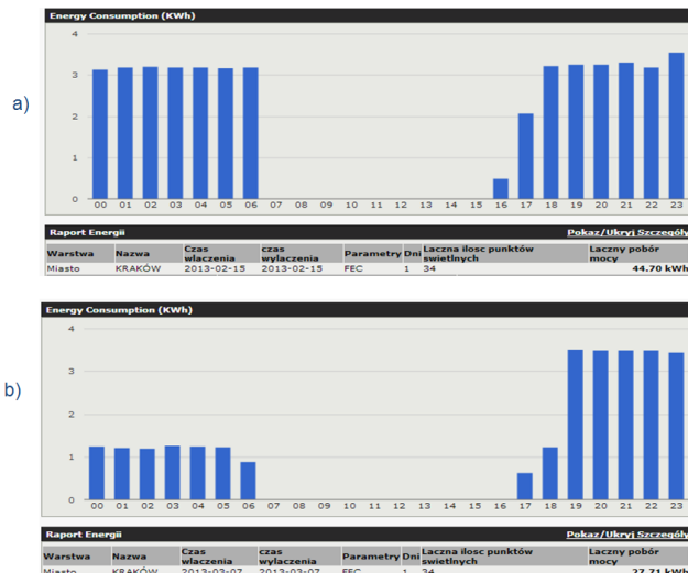
Rys. 4. Zużycie energii elektrycznej na ulicy Józefa Dietla w Krakowie: a) bez redukcji mocy b) z zaprogramowaną redukcją do 30% w godzinach 24-6.
